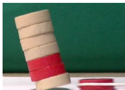
Zdj. 1. Obrót wieży wywołany wysunięciem bazy
